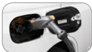
Connecteur de charge rapide Pour le chargeur rapide répondant au standard CHAdeMO
