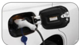
Connecteur de charge normale Pour une recharge sur une prise domestique.
